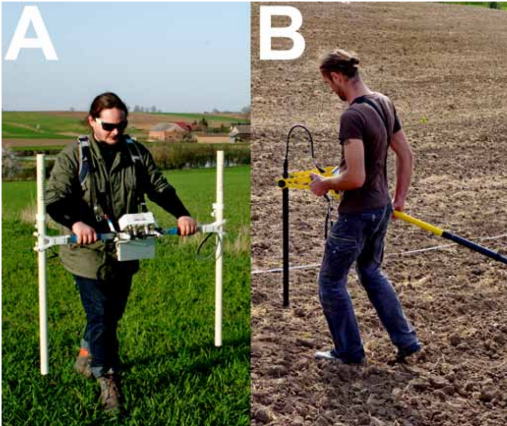
Ryc. 1. Magnetometry transduktorowe Bartington Grad601-Dual (a) oraz Foerster Ferrex 4.032 DLG (b) zastosowane podczas badań w Krzczonowicach (fot. P. Wroniecki)
